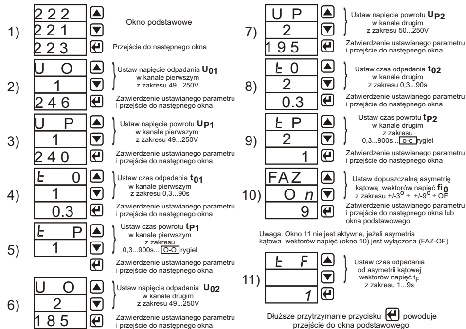
Rys. 2 Sposób ustawiania parametrów przełącznika PKF-333ZSE
